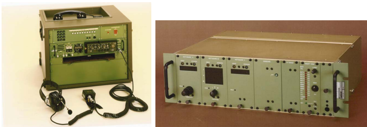
Radiostation RA 530 och radiostation RA 706.
