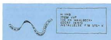
Vid fjärrskrift används speciella elektriska skrivmaskiner. Man skiljer mellan remsskrivare och blankettskrivare. Texten erhålles i det förra fallet på en pappersremsa och i det senare fallet direkt på en "blankett".
