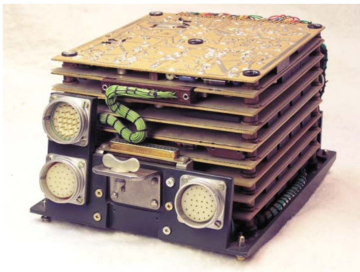
Registerenhet FD 11 med avtagen kåpa
