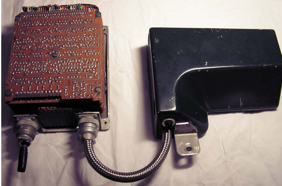
Styrdataomvandlare FD 10, programenheten med avtagen kåpa.
