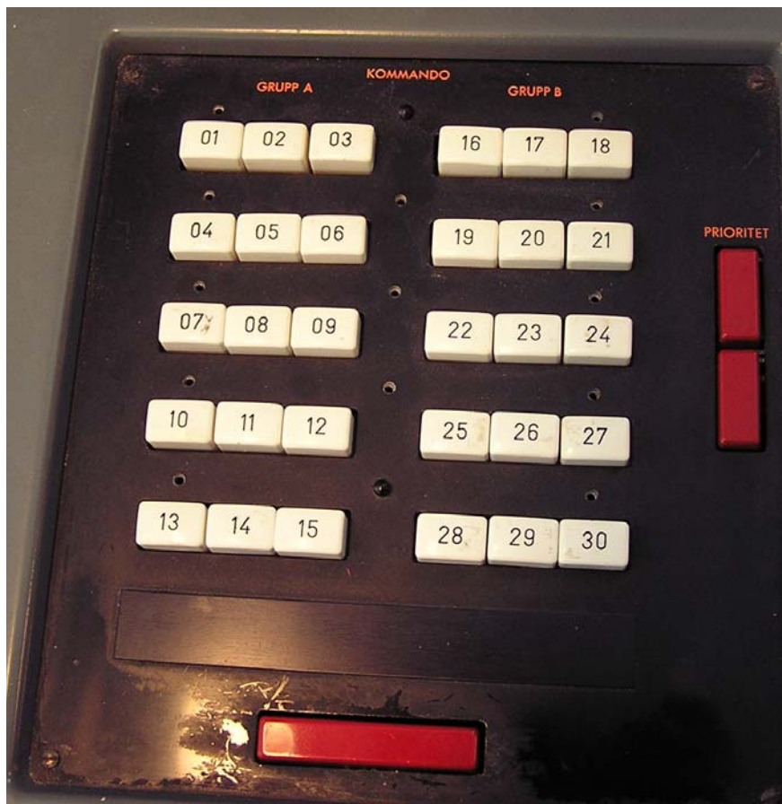
Kommandoväljare för styrdata (utan märkplatta).
