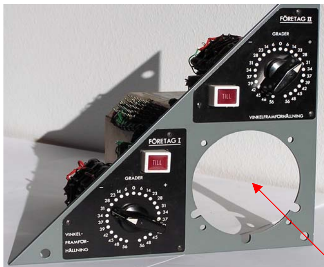
Inställningsorgan för vinkelframförhållning (för kurs)
